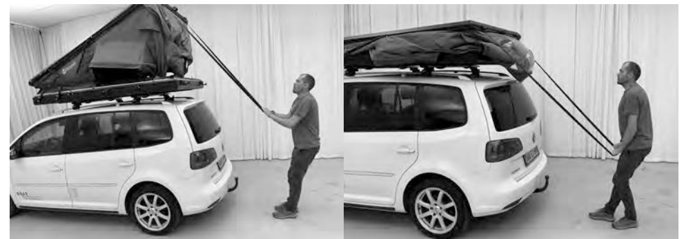
5.7) Détachez la sangle de traction. Tirez vers le bas pour fermer la tente.
