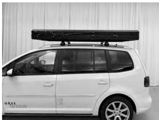
5.11) Před jízdou zkontrolujte, zda je stan stále bezpečně připevněn k vozidlu. V případě potřeby dotáhněte.
