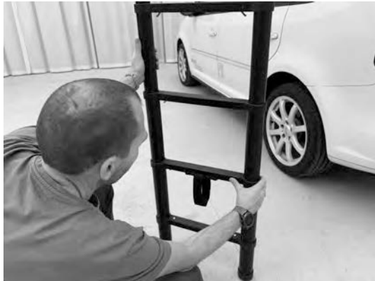
5.4) Refermez l'échelle. Déverrouillez un bouton coulissant à la fois tout en tenant le montant de l'échelle de l'autre main (pour éviter que l'échelle ne se replie sous son propre poids).
