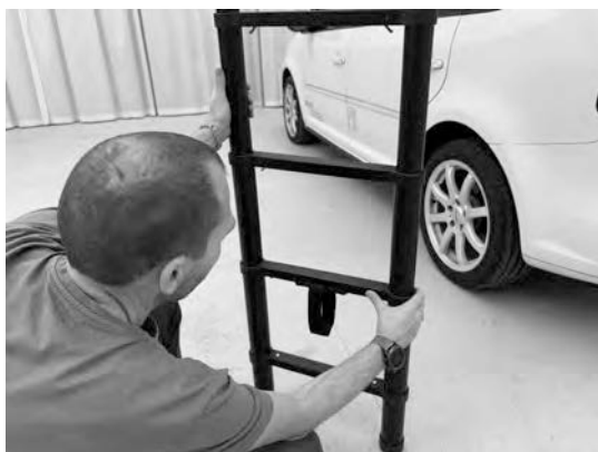
5.4) Luk stigen. Lås én glideskyder-knap op ad gangen, mens du holder på stigens vangestykke med den anden hånd (så stigen ikke klapper sammen af egen vægt). Se kapitel 6 "Stige" for detaljer om lukning af stigen.
