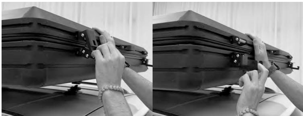
4.1) Åpne låsene helt i alle fire hjørner av teltet.
