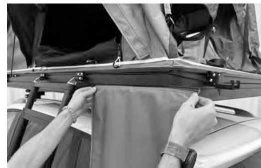
4.9) Fjern sko-posen fra teltet, og skub sko-posen ind i den nederste rille ved siden af stigen.
