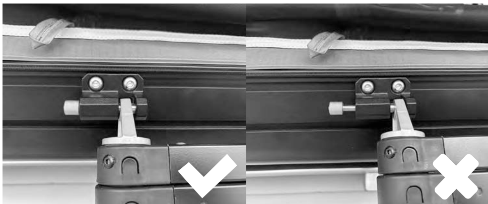
4.7) Připevněte žebřík k žebříkovým úchytům. Úchyty otevřete zatažením za pružinový knoflík. Ujistěte se, že se úchyty po namontování žebříku zcela uzavřou.
