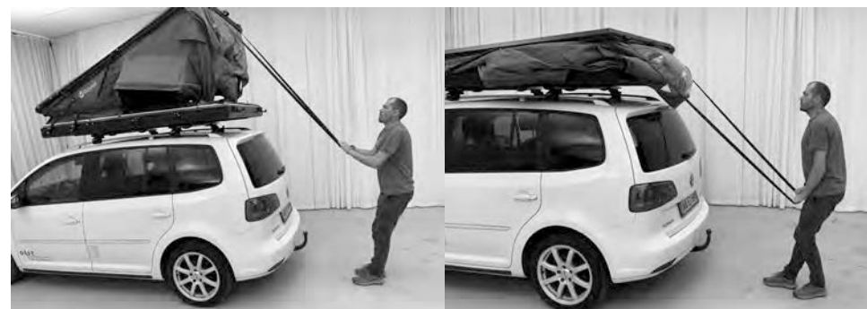
5.7) Løsn træknsoren. Træk nedad for at lukke teltet.
