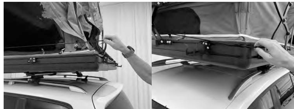
4.3) Odstraňte elastickou šňůru z plachty stanu a připevněte ji k rohům skořepiny. Opakujte u všech čtyř rohů, aby byla elastická šňůra zcela volná od plachty stanu.
