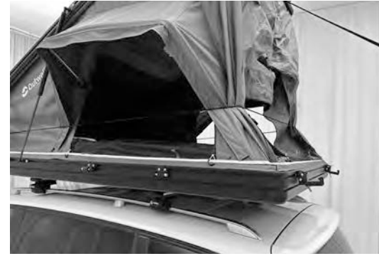
5.6) Remplacez le cordon élastique dans la position indiquée ci-dessus. Cela permettra de tirer la toile de tente vers l'intérieur lors de la fermeture.
