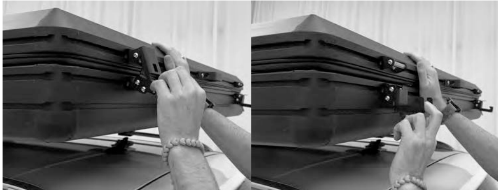
4.1) Öffnen Sie die Verschlüsse an allen vier Ecken des Zeltes vollständig.
