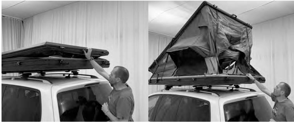
4.2) Öffnen Sie das Zelt, indem Sie den Griff nach oben drücken. Die Gasdruckfedern öffnen das Zelt dann vollständig.
