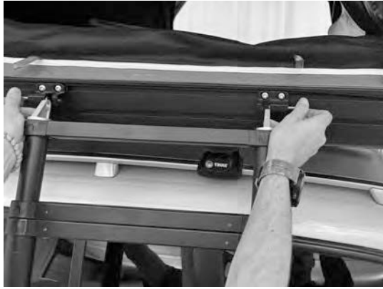
5.3) Retirez l'échelle en tirant sur les boutons des supports d'échelle.
