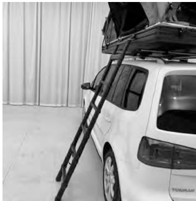
4.7) Befestigen Sie die Leiter an den Leiterhalterungen. Öffnen Sie die Halterungen, indem Sie den Federknopf ziehen. Stellen Sie sicher, dass die Halterungen nach der Montage der Leiter vollständig geschlossen sind.
