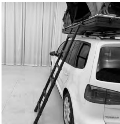
4.8) Stel de lengte van de ladder bij. Houd rekening met de hoekbeperking van de ladder van 65-75°. Zorg ervoor dat de treden van de ladder vanaf de onderkant naar boven worden vergrendeld.
