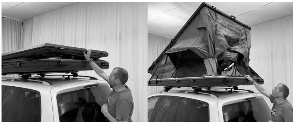
4.2) Åpne teltet ved å skyve håndtaket oppover. Gassdempere vil da åpne teltet helt.
