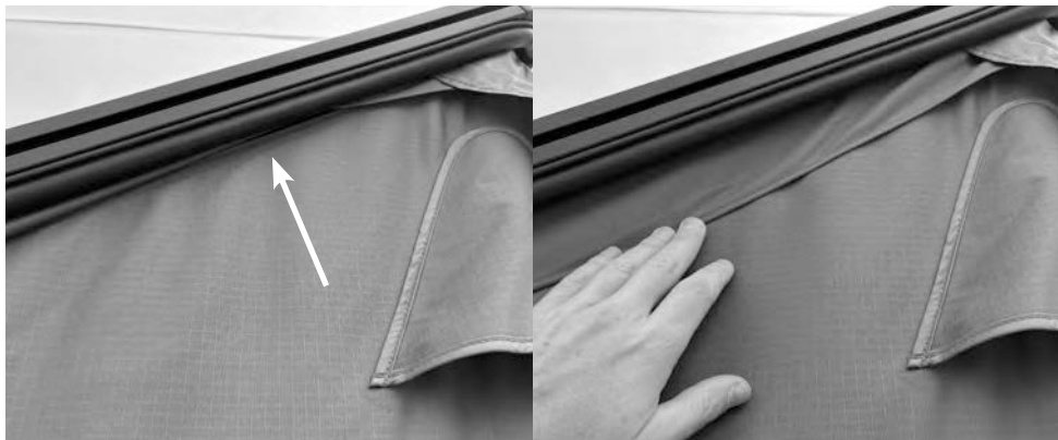
4.13) Soms kan het gebeuren dat de hierboven afgebeelde flap vast komt te zitten onder de rubberen strip van de bovenste schaal. Als dit gebeurt, trek dan de flap los om volledige bescherming in alle weersomstandigheden te garanderen.
