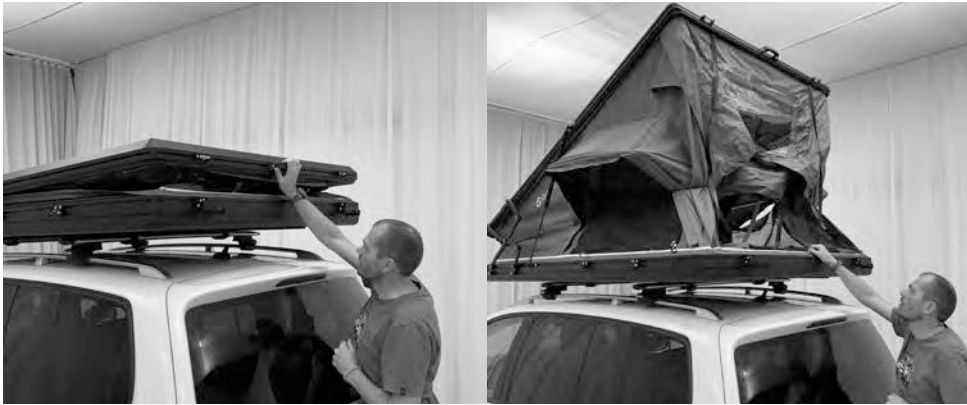
4.2) Open het tentdoek door de hendel omhoog te duwen. De gasveren openen het tentdoek vervolgens volledig.
