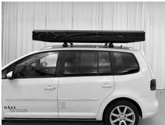
5.11) Kontrollér, at teltet stadig er sikkert fastgjort til køretøjet, før du kører. Efterspænd om nødvendigt.
