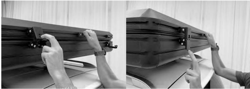
5.10) Schließen Sie die Verschlüsse, beginnend am hinteren Ende des Zeltes. Verwenden Sie dazu den Griff als Hilfe. Stellen Sie sicher, dass alle vier Verschlüsse vollständig geschlossen sind und dass kein Zeltstoff zwischen den Gummilisten der oberen und unteren Schale eingeklemmt ist.
