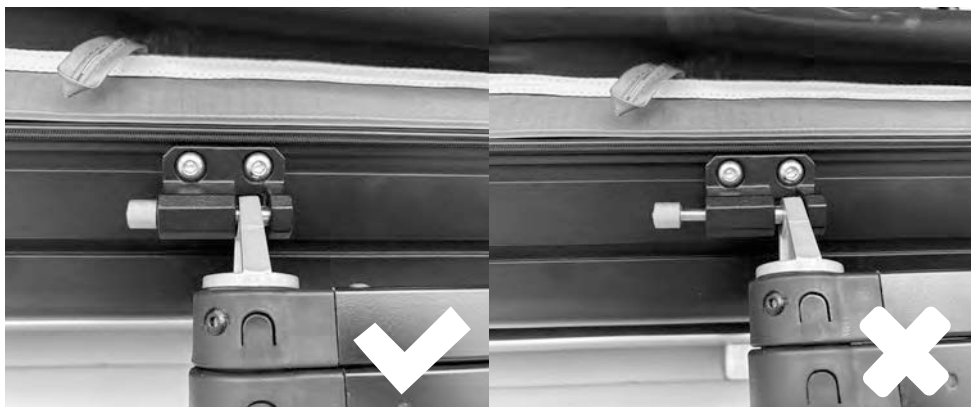
4.7) Fastgør stigen til stigebeslagene. Åbn beslagene ved at trække i fjederknappen. Sørg for, at beslagene lukker helt, efter stigen er monteret.
