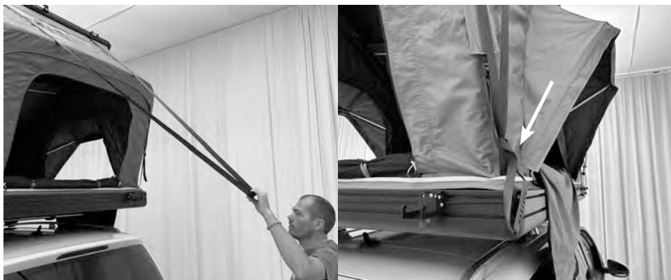
4.12) Připevněte tažnou šňůru k rohu krytu, aby se nehoupala ve větru.
