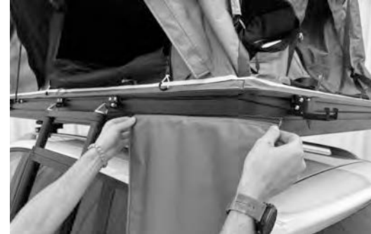
4.9) Retirez le sac à chaussures de la tente et glissez-le dans la rainure inférieure à côté de l'échelle.
