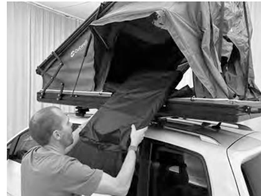
4.3) Entfernen Sie die Gummikordel von der Zeltplane und befestigen Sie sie an den Ecken der Schale. Wiederholen Sie dies an allen vier Ecken, damit die Gummikordel vollständig von der Zeltplane entfernt ist.
