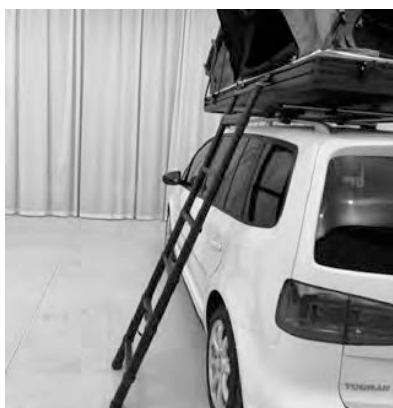
4.8) Upravte délku žebříku. Dodržujte omezení úhlu žebříku 65–75°.
