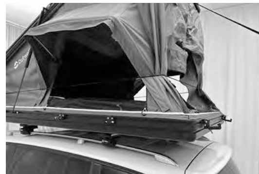
5.6) Flyt elastiksnoren til den position, der er vist ovenfor. Dette hjælper med at trække teltdugen ind i teltet, når det lukkes.
