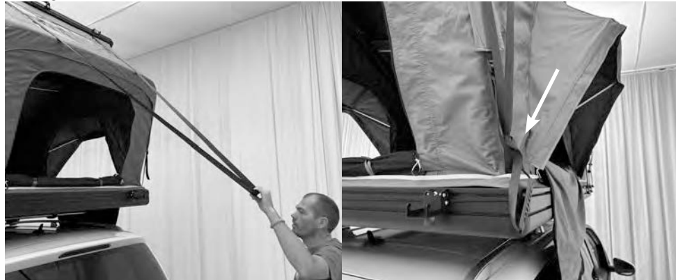
4.12) Befestigen Sie die Zugschnur an der Ecke der Abdeckung, um zu verhindern, dass sie im Wind flattert.
