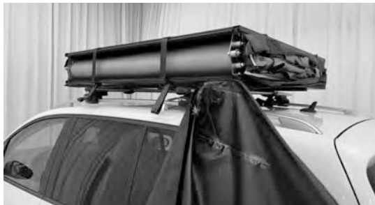
5.7) Schuif de rand van de transporthoes in de C-goot van de tent en schuif deze vervolgens helemaal op zijn plaats.
