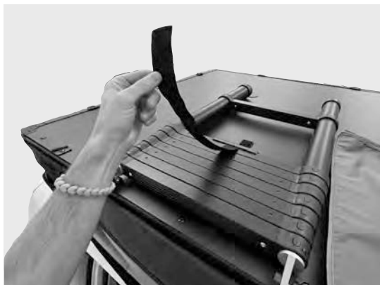
4.7) Løsn velcrobåndet på stigen. Læs kapitel 6 "Stige", inden du bruger stigen.
