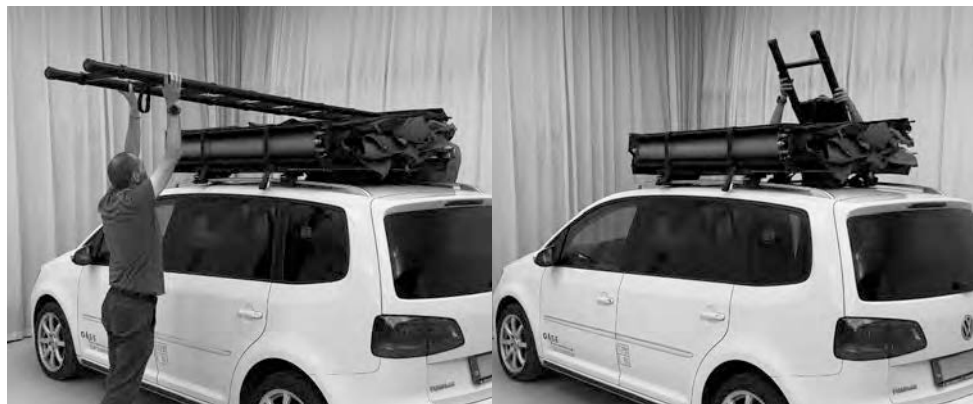
5.4) Stiskněte zajišťovací zápačky na žebříku a žebřík zcela složíte. Připevněte suchý zip na žebříku.
