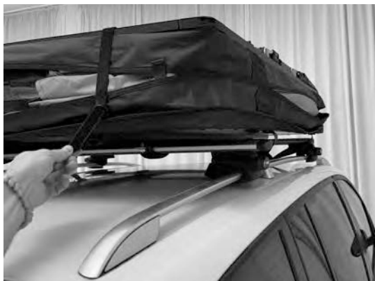
4.6) Åbn de to velcrobånd på teltets bageste hjørner.
