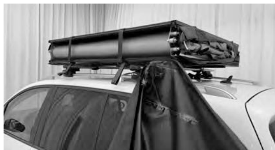
5.7) Zasuňte okraj přepravního krytu do C-kanálu stanu a poté jej zasuňte zcela na místo.
