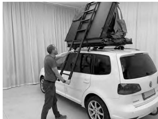
4.9) Tag fat i bunden af stigen. Træk stigen helt ud. Kontroller, at alle trin er låst fast.
