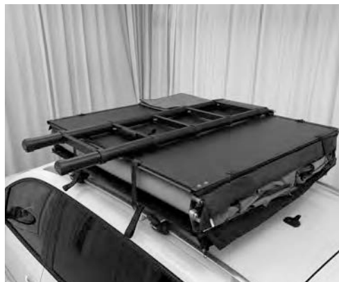
4.8) Udvid de første tre sektioner af stigen, så bunden af stigen kan nås fra den anden side.
