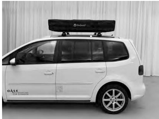
5.11) Controleer voordat u wegrijdt of het tent nog steeds stevig aan het voertuig is bevestigd. Span indien nodig nogmaals aan.
