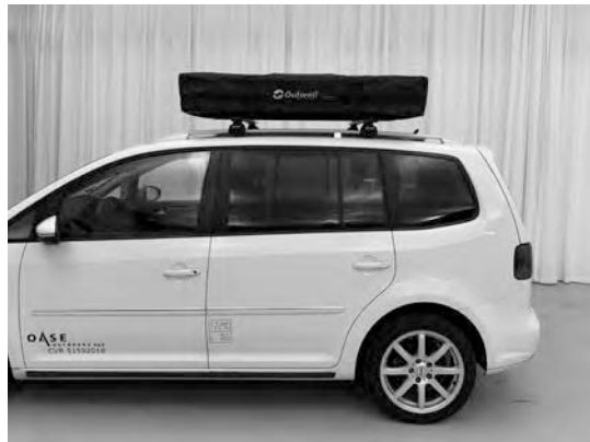
5.11) Vergewissern Sie sich vor der Abfahrt, dass das Zelt noch sicher am Fahrzeug befestigt ist. Ziehen Sie gegebenenfalls die Gurte nach.
