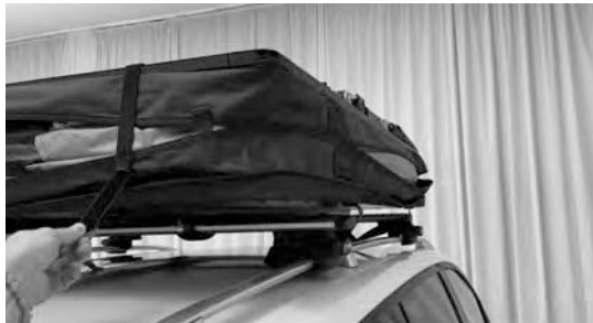
5.6) Lukk de to borrelåsstroppene på de bakre hjørnene av teltet.
