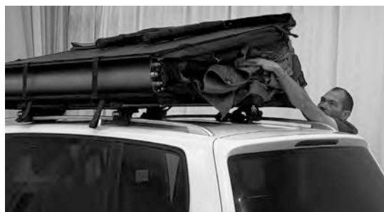
5.5) Zvedněte horní část dna stanu a zastrčte všechny látkové části dovnitř. Poté látku odtáhněte od zipu, aby se zip nezachytil o okraj látky.
