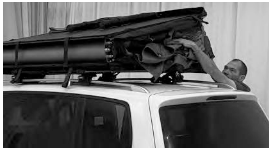
5.5) Heben Sie den oberen Teil des Zeltbodens an und stecken Sie alle Stoffteile hinein. Ziehen Sie dann den Stoff vom Reißverschluss weg, damit sich der Reißverschluss nicht im Stoffrand verfängt.
