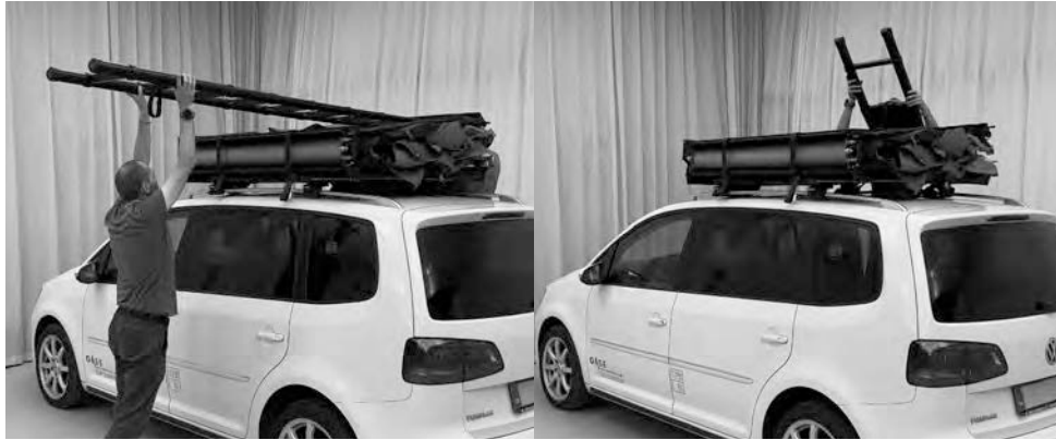
5.4) Trykk på låsetappene på stigen og skyv stigen helt sammen. Fest borrelåsstroppen på stigen.
