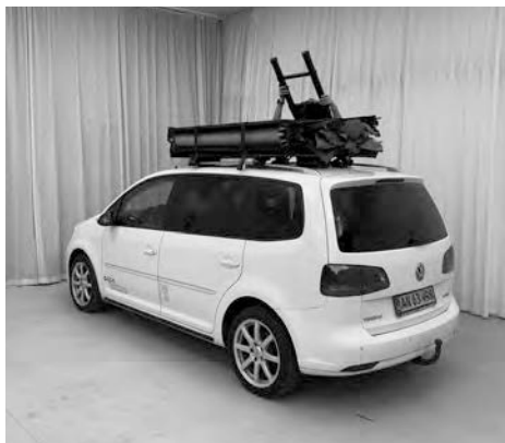
4.8) Udvid de første tre sektioner af stigen, så bunden af stigen kan nås fra den anden side.
