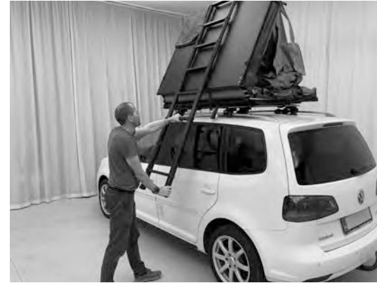
4.9) Ta tak i bunnen av stigen. Trekk stigen helt ut. Kontroller at alle trinnene er låst på plass.
