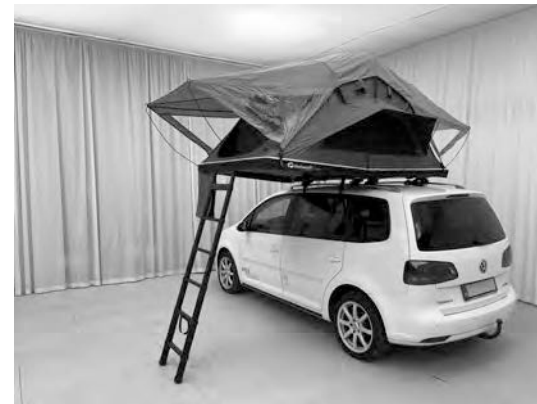
4.11) Juster lengden og vinkelen på stigen slik at den støtter teltet. Overhold begrensningene for stigens vinkel på 65°-75°.
